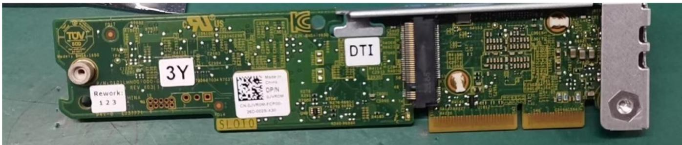
图 12: 适用于 4 x 3.5 英寸、8 x 2.5 英寸、10 x 2.5 英寸配置的 BOSS-N1 控制器
