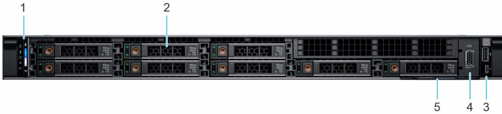
图 2: 8 x 2.5 英寸驱动器系统的前视图
